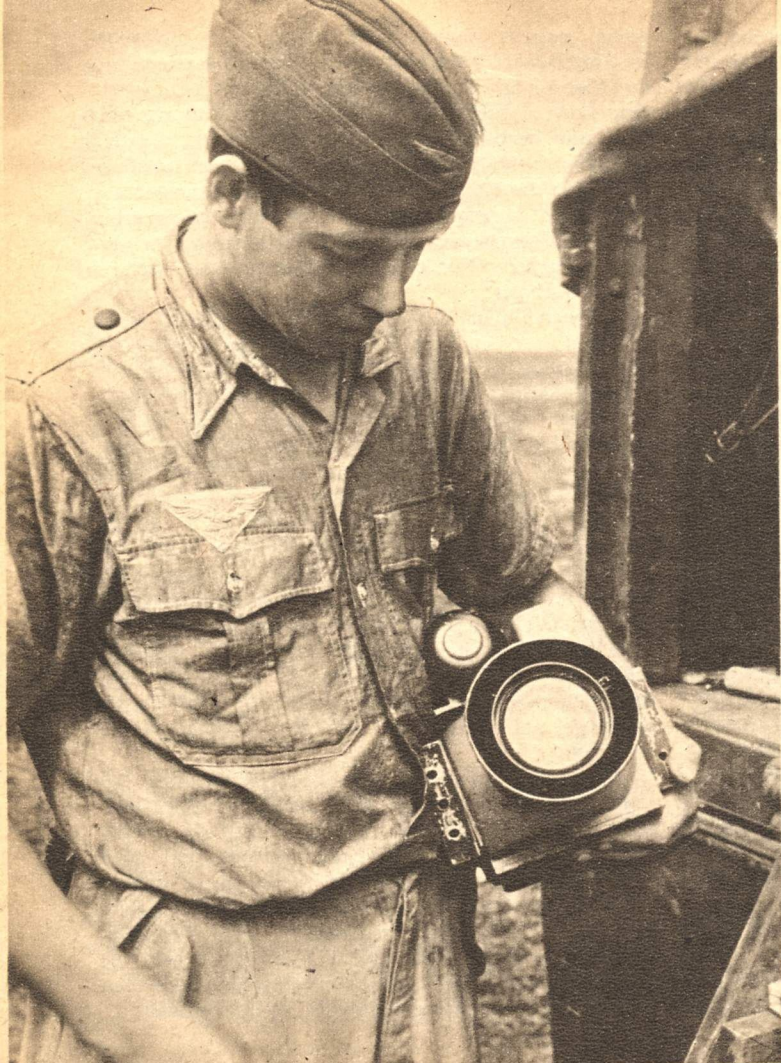
Die „Augenhöhle“. Blick auf die Einhängenvorrichtung und die Reihenkameras im Rumpf des Jagdflugzeugs Me 109. — Links: Der Wart empfängt nach dem Wechsel der Filme die neu geladene Kamera, um die Jagdmaschine als Aufklärer einsatzbereit zu machen
