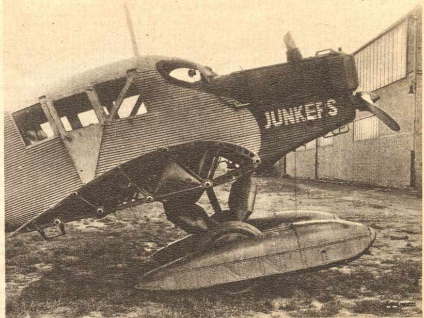
Die verdienstvolle Junkers F 13, das erste Verkehrsflugzeug im Ganzmetallbauweise. Es wurde gelegentlich, wie das Bild zeigt, auch mit Schneekufen ausgerüstet. Deutlich ist der im Tragflügel untergebrachte Kraftstofftank zu erkennen
